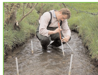
Mesure d'oxygénation du fond du cours d'eau
