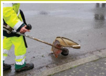
Débroussailleuse avec dispositif anti-projection
