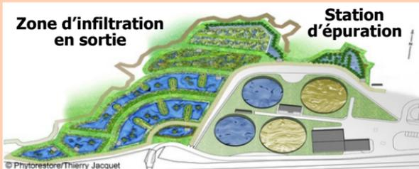
Les rejets des stations d'épuration doivent s'adapter au débit des cours d'eau : l'implantation de « jardins d'eau » permet de finir d'épurer l'eau, de l'infiltrer voire de supprimer les rejets en été.
