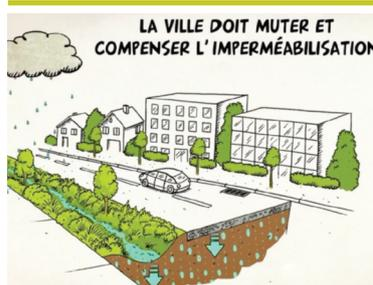
La ville doit donc muter et limiter l'imperméabilisation. L'eau ne peut plus s'infiltrer à la parcelle, mais elle peut être gérée à l'échelle d'un quartier. Il faut alors infiltrer ces eaux de ruissellement durant leur transport.
