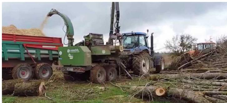
Broyeur à copeaux, bois bocage
